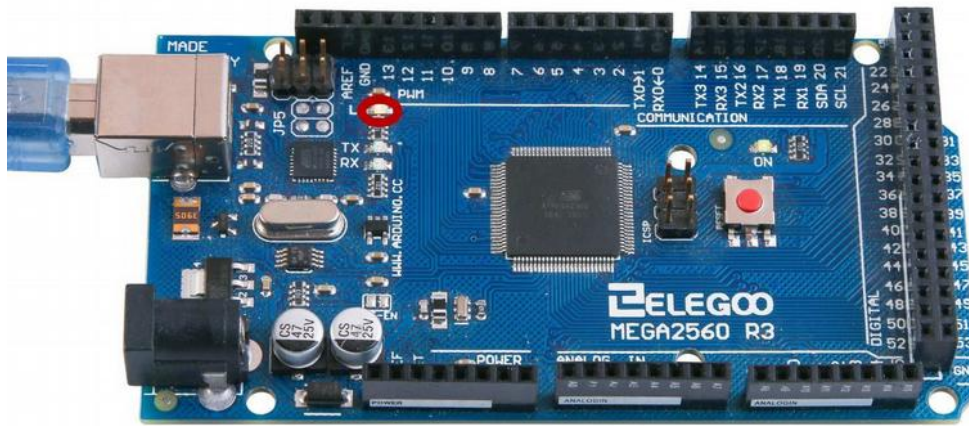
Figura 3. Situación del led L en la placa Elegoo Mega2560 R3 (marcado en rojo en la imagen). [7]
