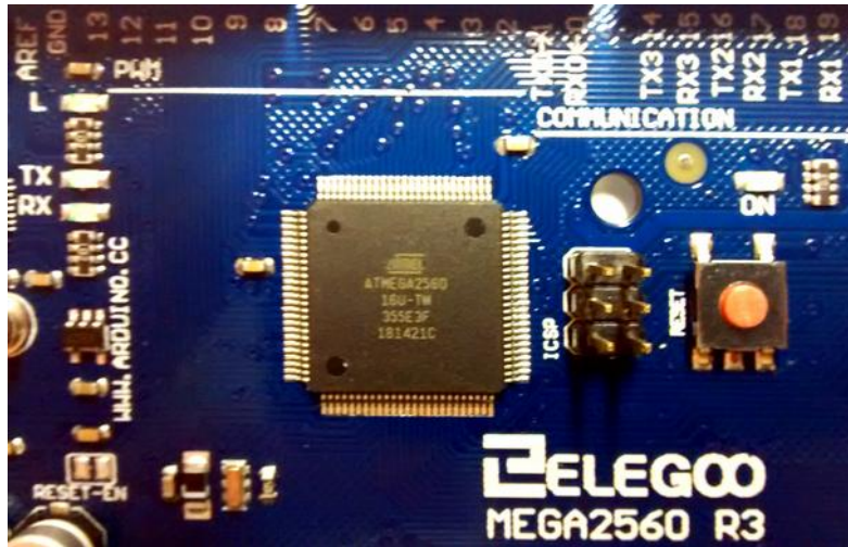
Figura 2. Detalle de la placa Elegoo Mega2560 R3 con el microcontrolador ATmega2560 [1].
